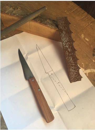
**Fabrication d'un couteau** ou autre outil à partir de **chutes de lames** de scie à grumes et de **chutes de bois** sans utilisation d'énergie fossile ou forge (100% Low-Tech).
